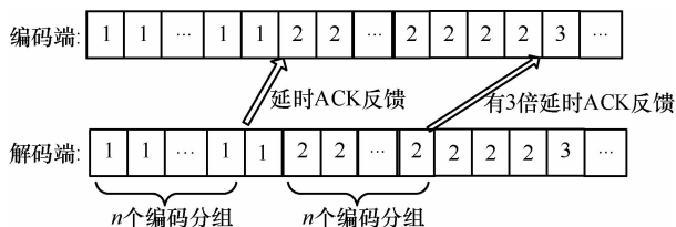
图4 反馈 ACK 有延时下的 LT 编码
